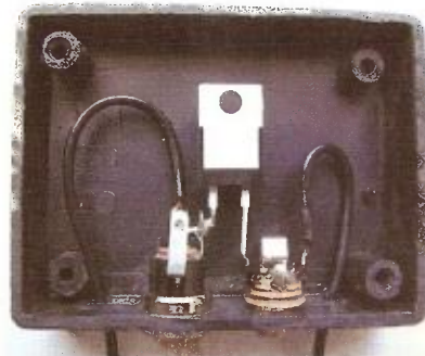
Obr. 7. Krabička, přilepená na zadní straně fotovoltaického panelu, obsahuje výstupní konektor, Schottkyho diodu a konektor s rozpojovacím kontaktem pro indikátor nabíjecího proudu
