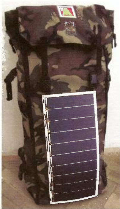
Obr. 5. Pružný fotovoltaický panel typu 10SC1 je upevněný na tlumoku v osmi bodech
