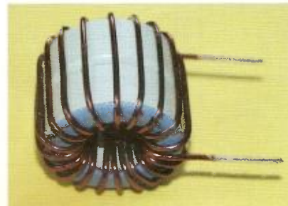
Obr. 4. Navinutá sendvičová akumuláční tlumivka
