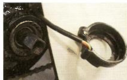
Obr. 9. Generátor PAS magnetický - kompaktní - stator
